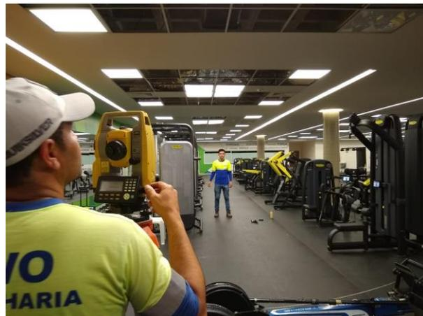
Para o cálculo inicial das medições foram atribuídas aos pontos da poligonal, coordenadas arbitrárias processadas através de software topográfico com origem no vértice V-2 de Coordenadas N=10.000,000 e E= 5.000,00.
